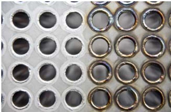
Vergleich Schweißnähte gebeizt (links) und unbehandelt (rechts); Material 1.4301
