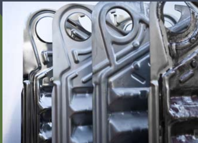
Plattenwärmetauscher (v.l.n.r.) elektropoliert, gebeizt, metallblank, mit Rougebelegung
