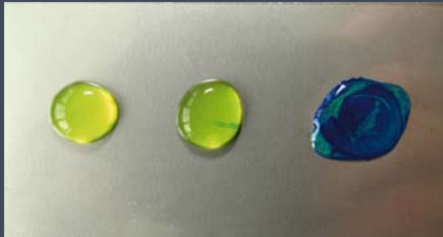
Abbildung 1: Beispiel für Ergebnis Ferroxyltest; linker Bildteil kein Farbumschlag | mittlerer Bildteil lokaler Farbumschlag | rechter Bildteil Farbumschlag vollflächig auf blau.
