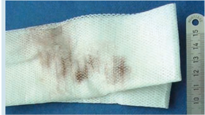
Abbildung 9: Abwischprobe einer rougingbehafteten Edelstahloberfläche [6]
