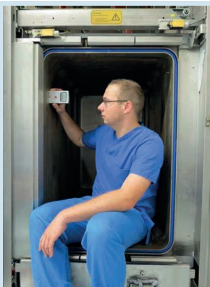
Abbildung 11: Qualitätssicherungsmaßnahme (Oberflächenrauheitsmessung an der Kammerinnenoberfläche) (Quelle: Firma Henkel Beiz- und Elektropolieretechnik)
