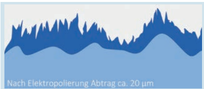
Abbildung 14: Schematische Darstellung der Oberflächenkontur vor (dunkelblaue Topographie) und nach (hellblaue Topographie) [4]
