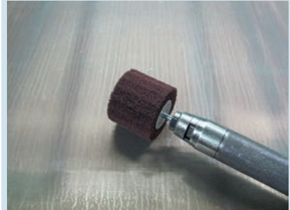
Abbildung 12b: Mechanische Sanierungsmaßnahmen (Quelle: Firma MMM)
