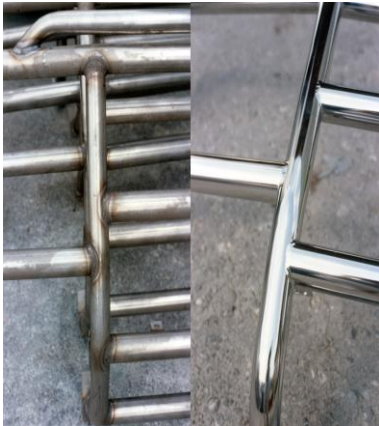
Edelstahl-Geländer vor und nach elektrochemischer Polierung, Werkstoff 1.4301
