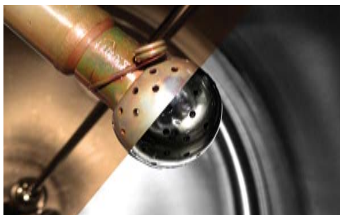
Vor-Ort-Team Deutschland 2017 (oben); Derouging eines Edelstahltanks vor und nach Vor-Ort-Einsatz (unten)
