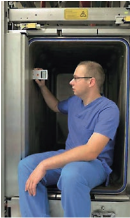
Abb. 3: Qualitätssicherungsmaßnahme (Oberflächenrauheitsmessung an der Kammerinnenoberfläche) [1]
