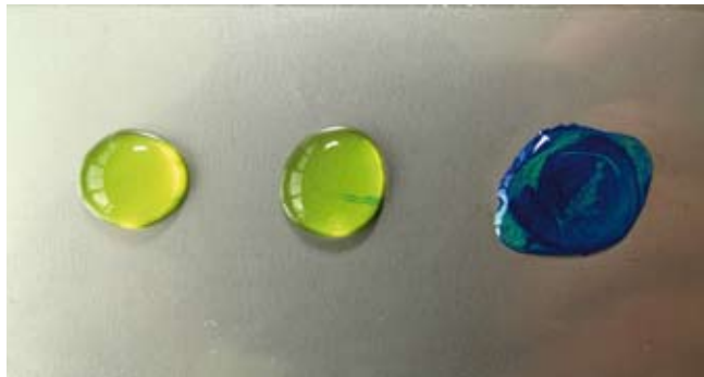
Abbildung 1: Beispiel für Ergebnis Ferroxyltest; linker Bildteil kein Farbumschlag | mittlerer Bildteil lokaler Farbumschlag | rechter Bildteil Farbumschlag vollflächig auf blau.
