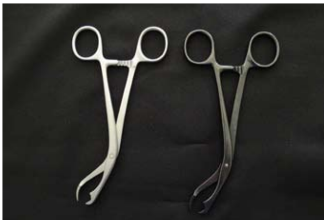
Chirurgisches Instrument | links nach der Aufbereitung durch HENKEL | rechts mit Belagsbildung | Material: 1.4116 / 420MoV
