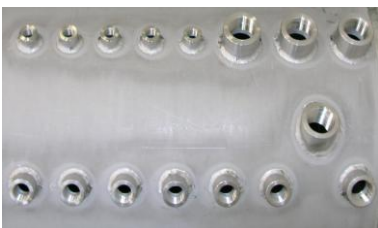
tartály 1.4435-ös anyagból kezeletlen, ill. kémiailag pácolt, passzívált felület
