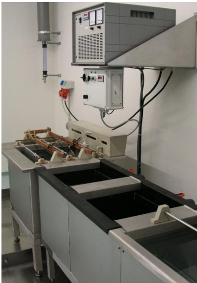
Hand-Elektropolierbad für Kleinteile (Medizintechnik)
