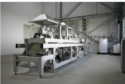
Elektropolieranlage für Sonderteile (Grundlagenforschung Physik)
