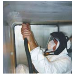
Mechanischer Verschleiß bei extremer Belagsbildung
