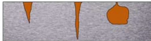
Typische chloridinduzierte Lochkorrosion (LK)
