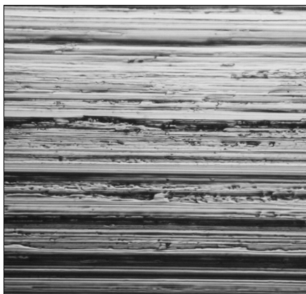
Die Abbildungen zeigen jeweils eine 500-fache Vergrößerung einer Rohrinnenoberfläche aus 1.4404/316L-Links: mechanisch geschliffen und rechts: elektropoliert nach VHE175.
